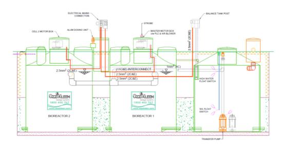
Figure 3. RP20A INTER CONNECTION ELECCTRICAL LAYOUT
